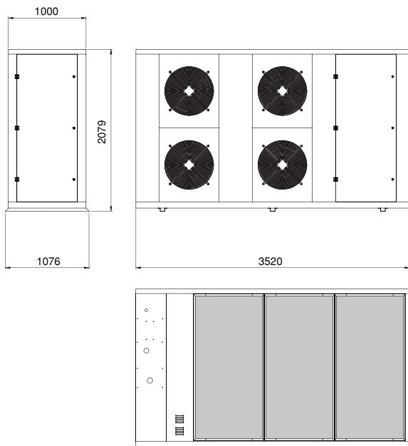
Refrigeratori di acqua glicolata con doppio sistema di regolazione del circuito frigorifero per ottimizzare le prestazioni della macchina sia in alta che in bassa temperatura.
